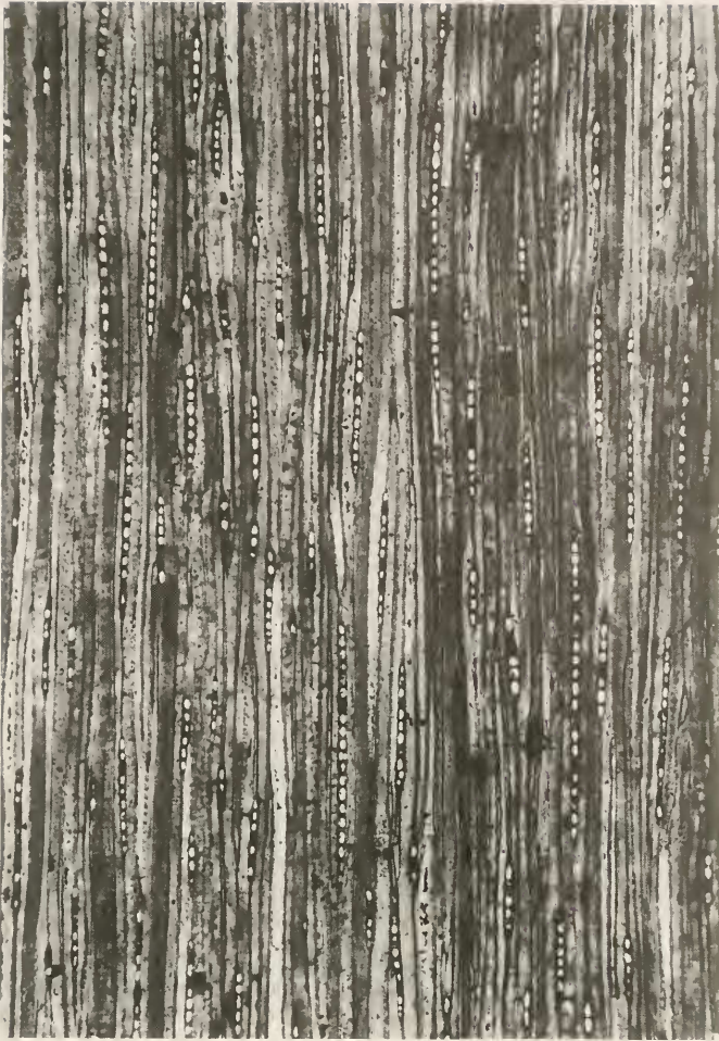
Abb. 7. Gymnospermen-Xylem, Fundort Sengenthal. – Tangentialschliff mit relativ hohen, ausschließlich einreihigen Holzstrahlen. x 70.
